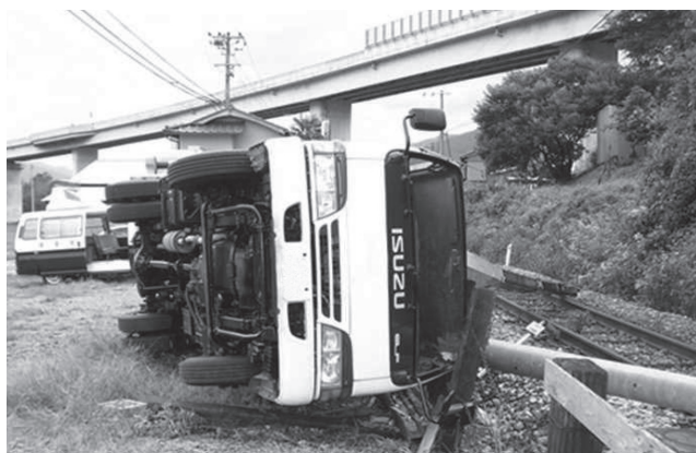
土讃線佃駅構内クレーン車転倒事故
