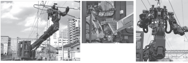
「人型重機ロボット車」2022年4月から試作機での試験実施 これまで人の手で行ってきた高所作業を遠隔操作によるロボットで人と同様に様々な部品を把持することが可能で、多様な状況の作業に対応できる。地上の車両操縦席から操作するため安全性も高い。 JR西日本では2022年4月から架線部品の取替え、架線支持物の塗装、樹木の伐採作業などの試作機での試験を実施。2024年春からの実用化・営業線での導入を目指している。
